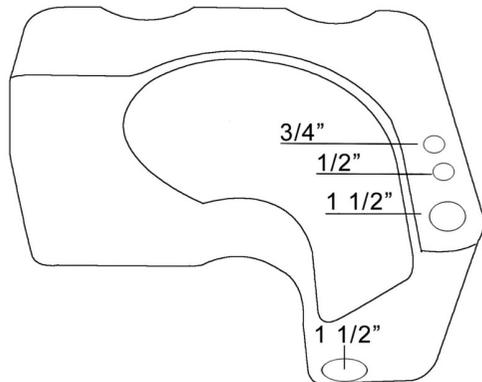
Wird um das WC herum installiert. Passt zu den meisten bestehenden WCs Für eine korrekte Installation sollten manuelle und elektrische Toiletten mit einer Bypass- und Abflusspumpe ausgestattet werden. Die Pumpen können entfallen, wenn die Entleerung über den "Abwasser" -Anschluss an Deck erfolgt.
