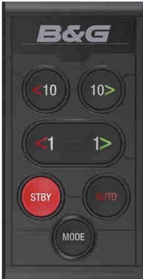
Die kabelgebundene Fernbedienung kann mit dem Triton<sup>2</sup> Digitaldisplay gekoppelt werden, um ein eigenständiges Autopilot-Bedienfeld zusammenzustellen, oder als dedizierte Autopilotentastatur für Simrad Multifunktionsdisplays verwendet werden. Diese Tastatur ergänzt das flache Design der Glass Bridge-Geräte und -Displays und lässt sich nahtlos in jeden Steuerstand integrieren.
