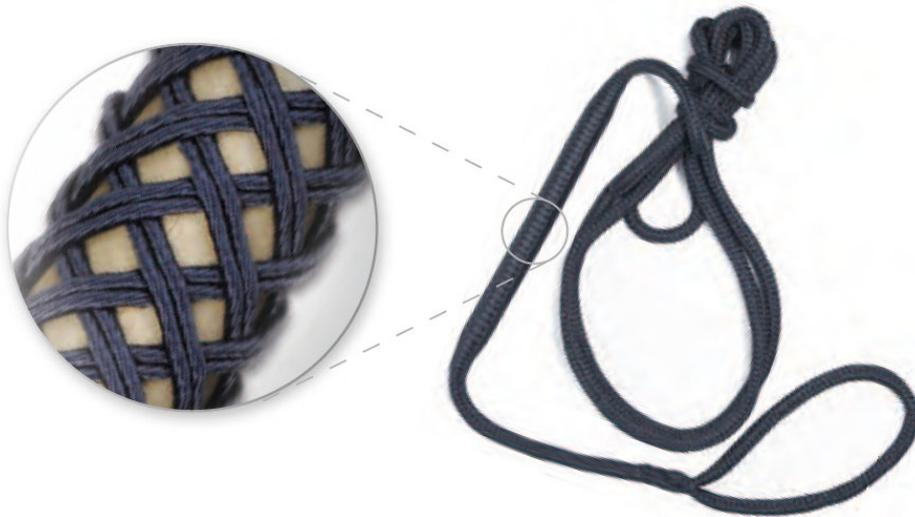
Die Miami verbindet hohe Abriebfestigkeit mit guten Dehnungseigenschaften und einem Ruckdämpfer. Das Seil aus hochwertigem, 12-fach geflochtenem Polyester wurde mit einem integrierten, hochbelastbaren Gummi-Ruckdämpfer versehen, was zu besten Dämpfungseigenschaften führt. Der integrierte Augspleiß macht die Miami sofort einsatzbereit
